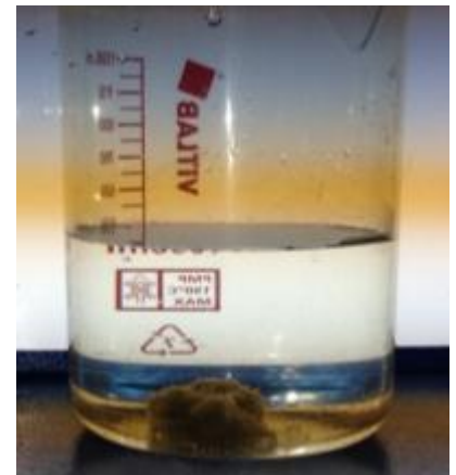
Acqua di galleria + PAC + polielettrolita Tunnelabwasser + PAC + Polymer
