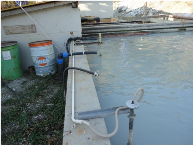
Messeinrichtungen pH, Feststoffe in Vorsedimentation
