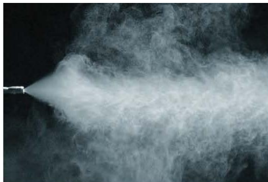
Figura 22: Dettaglio dell'ugello nebulizzatore
