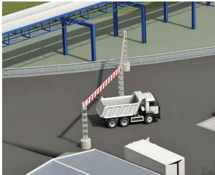
Abbildung 40: Baustelle Hinterrigger – Portal als Schutz vor Freileitungen
