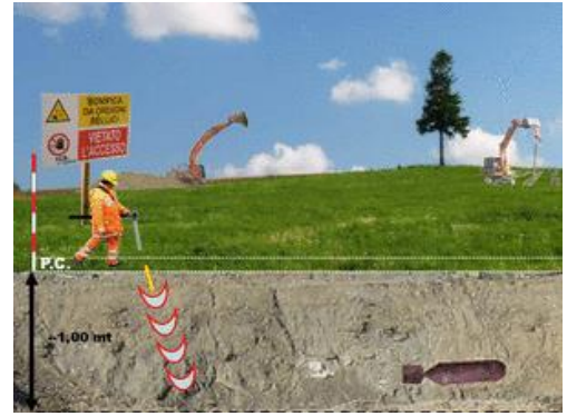
Figura 3: Bonifica superficiale – Fase 1
