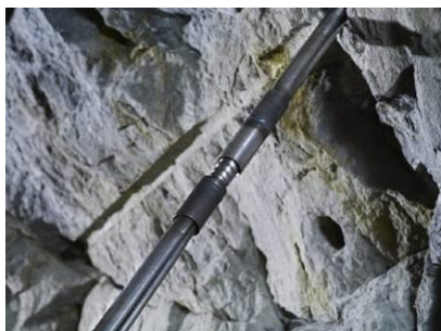
Abbildung 7: Ankern Typ „Swellex“
