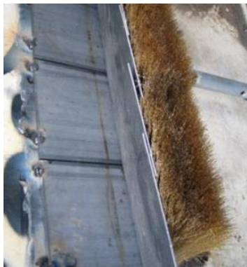
Abbildung 4: Detail Dichtungsbürsten am TBM-Schildschwanz
