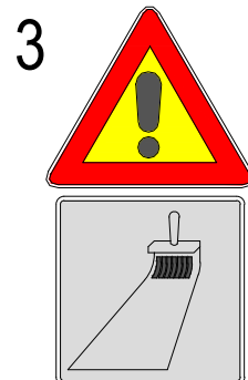
FIG. II 391 Art.31 - SEGNI ORIZZONTALI IN RIFACIMENTO
