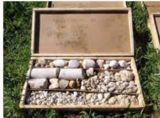
Figura n. 23: sondaggio n. 5 -cassette 1 e 2 -caratteristiche tessurali spessori alluvionali; parte superficiale prevalentemente limosa (CEC1)passante verso il basso ad una frazione più grossolana (CEC2)
