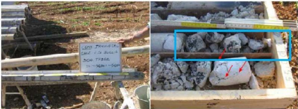
Figura n. 24: sondaggio TPB02 dettaglio sulla mineralizzazione a bitume
