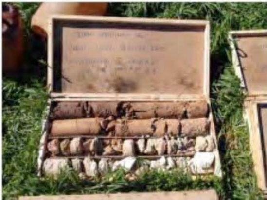
Figura n. 23: sondaggio n. 5 -cassette 1 e 2 -caratteristiche tessurali spessori alluvionali; parte superficiale prevalentemente limosa (CEC1)passante verso il basso ad una frazione più grossolana (CEC2)
