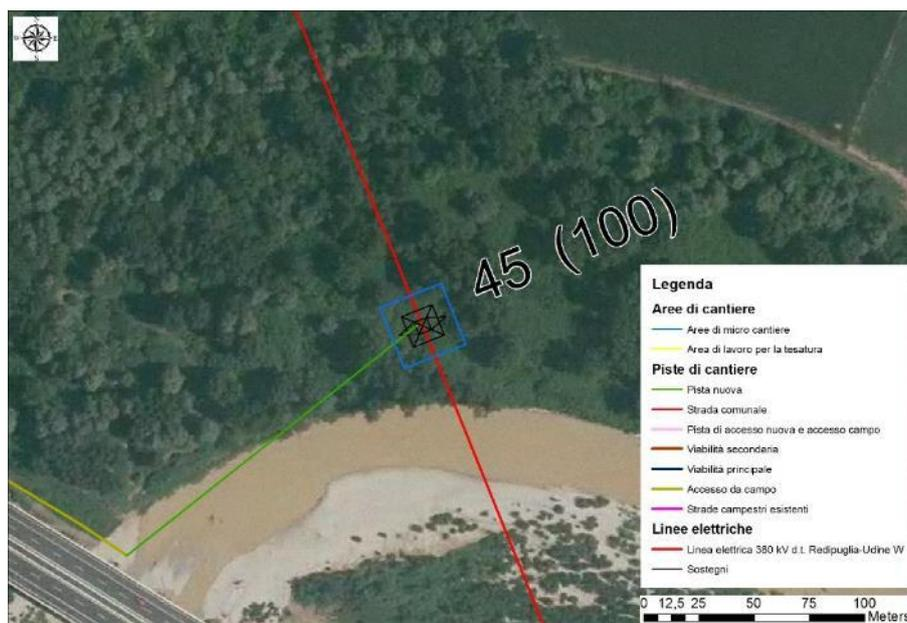
**Figura 14 – Sovrapposizione del tracciato col sostegno 45 ex100) su ortofoto**
