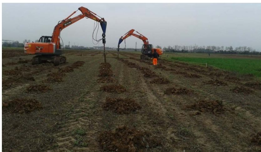
Fig. 2a: trivella utilizzata dagli sminatori e alcuni fori facenti parte della griglia regolare.
