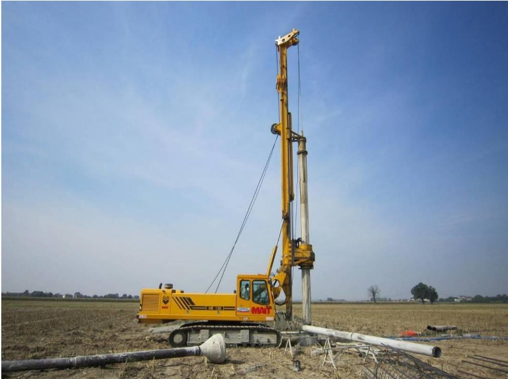
**Figura 67 - Macchina operatrice per la realizzazione di pali trivellati**
