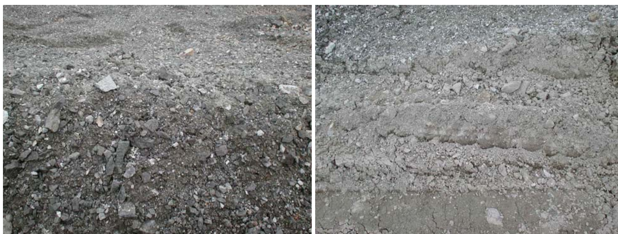
Fig. 4: Dettaglio delle caratteristiche fisiche dello smarino. A sinistra gneiss frantumato in blocchi di dimensioni variabili da centimetriche a decimetriche; a destra è visibile la matrice argillosa.
