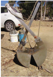
Figura 5.5.1 - La benna Van Veen utilizzata per i campionamenti.
