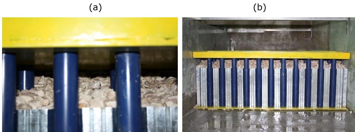
Figura 5.13 Banchina su pali e palancole: (a) particolare della scogliera interna alla camera assorbente; (b) vista del modello della banchina su pali e palancole messa in opera all'interno del canale di simulazione.
