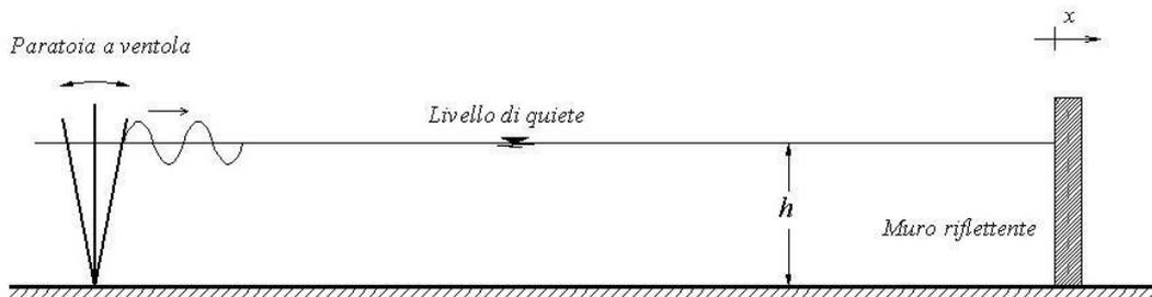
Figura 2.1 Schematizzazione del problema della riflessione di un'onda che incide su di un ostacolo verticale.
