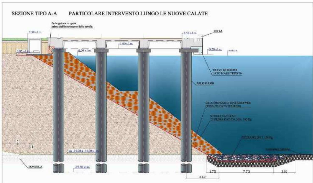
Figura 7 – Sezione A-A – Banchinamenti
