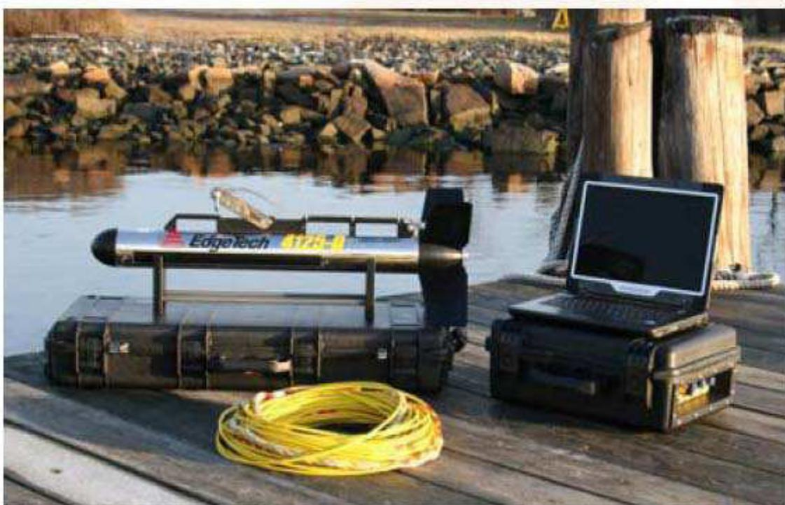
*Figura A: Processore, trasduttore e monitor del sistema S.S.S 4125*
