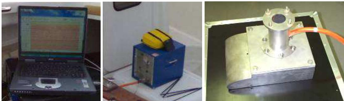
Figura A: Sistema SES da sinistra verso destra sono raffigurati il LapTop, il processore e trasduttore.
