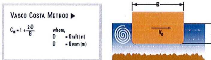
Figura 3 Schema di coefficiente di massa aggiuntiva (fonte PIANC Report of working group n°33)
