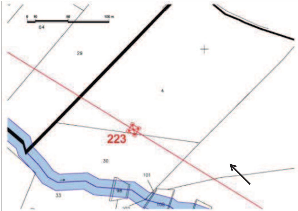
Figura 5.8: Rappresentazione, sulla base cartografica catastale, della distanza (azzurro - 10 m) dall'alveo del Fosso della Conca rispetto alla posizione del sostegno 223 dell'elettrodotto Gissi – Larino - Foggia. La freccia nera indica il verso della ripresa fotografica.
