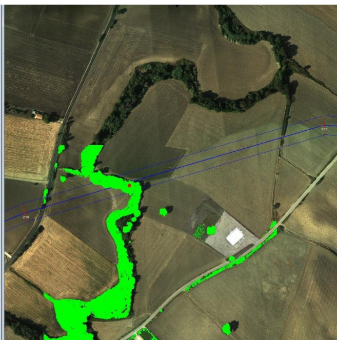
Figura 2 – Torrente Sinarca, stato dei luoghi e rilievo Lidar della vegetazione
