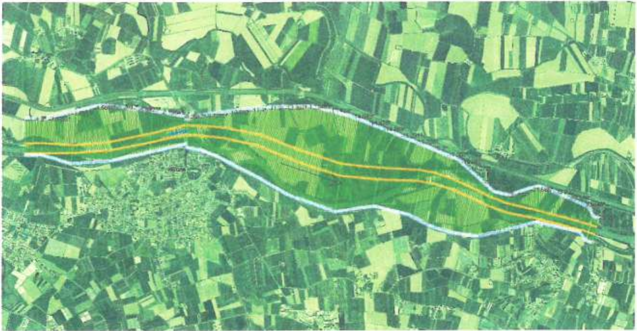
Figura 7: zoom sull'area della cava di progetto, nell'immagine di mostra l' ipotesi di ricentralizzazione dell'alveo di magra – Golene interessate dall'abbassamento (Fonte: Studio per il recupero naturalistico e morfologico del fiume Adige, Tratto Pontoncello – Tombazosana" ,Autorità di Bacino del Fiume Adige, 2007).
