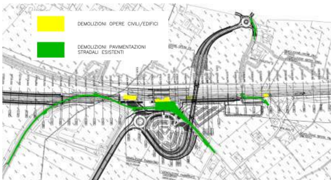
Figura 33: Demolizioni previste per la realizzazione della “VARIANTE SUD” 19
