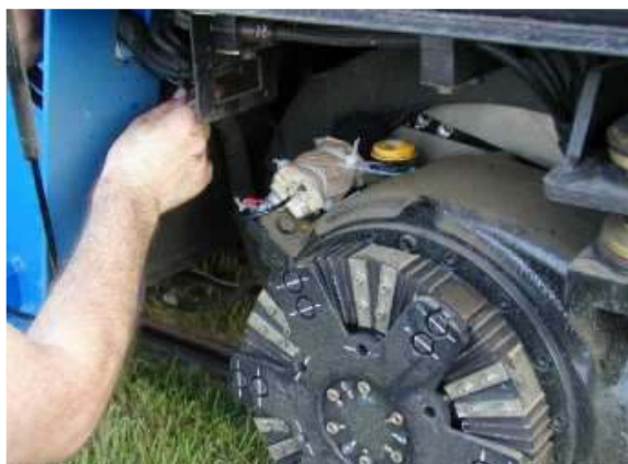
Fig. 24 Montaggio di un silenziatore di ruota ad anello assorbente.
