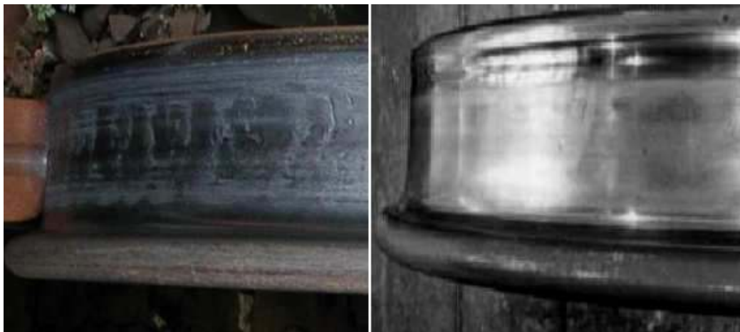
Fig. 21 : effetti dell'azione dei freni sulla ruota A sinistra freni a ceppi di ghisa ed a destra freni in materiale composito
