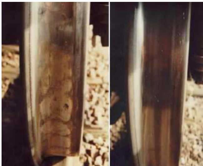
Fig. 20 : efficacia della riprofilatura della ruota ante e post opera (rispettivamente a sinistra ed a destra)
