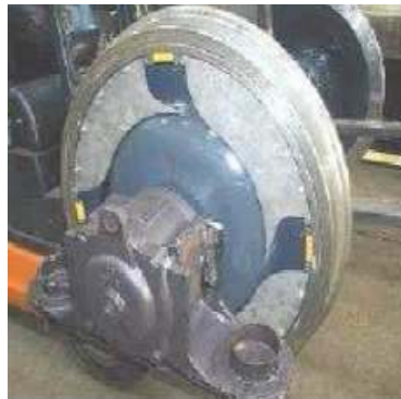
Fig. 23 : Ruote silenziate con assorbitori in acciaio
