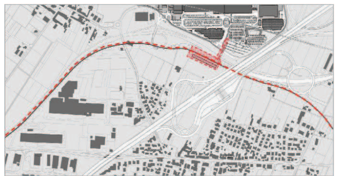
Figura 3.2.2 – Nuova linea ferroviaria (attuale ipotesi progettuale)
