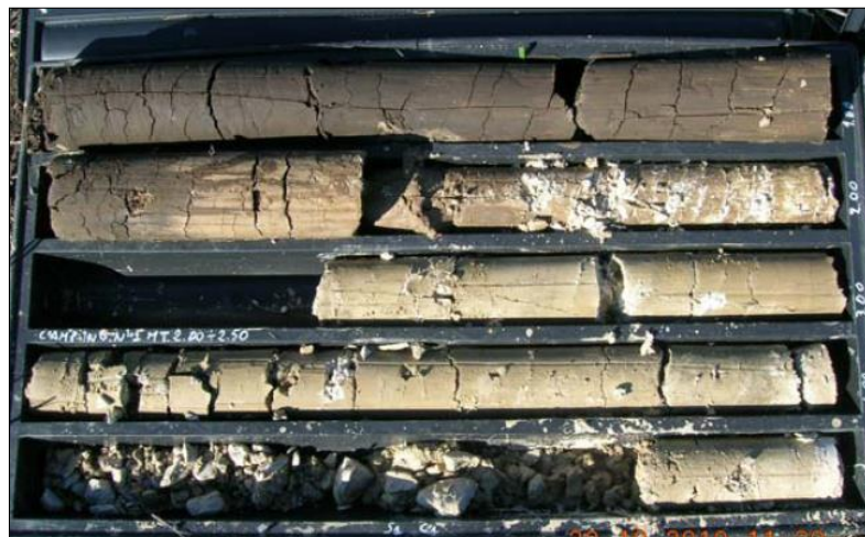
Figura 3.2.1-1 – Foto della cassetta n.1 del sondaggio S1, da 0 a 5 m di profondità. Si evidenzia la presenza dei depositi di copertura eluvio-colluviale per oltre 1 m, e nella parte bassa, i depositi alluvionali antichi che caratterizzano il top delle superfici pianeggianti dei terrazzi fluviali lungo i quali si sviluppa gran parte della linea in progetto.
