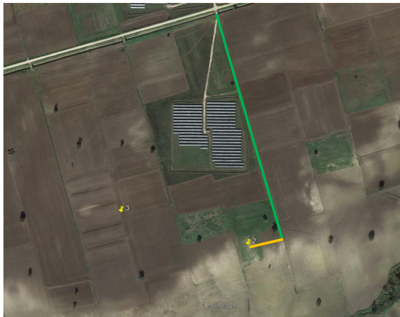
Figura 2.2.6-5 – Ortofoto con diversa pista di cantiere per accesso al sostegno n. 2
