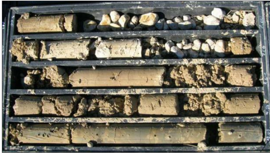
Figura 3.2.1-2 – Foto della cassetta n.2 del sondaggio S1, da 5 a 10 m di profondità. In alto i depositi ghiaiosi in matrice limo-sabbiosa argillosa riferibili alle alluvioni antiche e terrazzate; in basso, il passaggio alle sottostanti argille grigio-azzurre, costituenti il substrato geologico dell'intera area interessata dalla realizzazione della linea elettrica.
