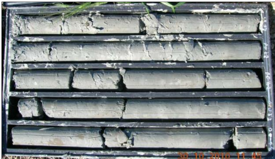
Figura 3.2.1-3 – Foto della cassetta n.6 del sondaggio S1, da 25 a 30 m di profondità. L'intera verticale in questo tratto è interessata dalla presenza delle argille grigio azzurre, particolarmente omogenee, della formazione di Montesecco.
