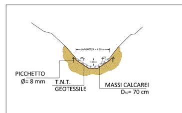
SEZIONE TIPO SISTEMAZIONE IDRALICA FOSSO LA FRANCA - SCALA 1:200
