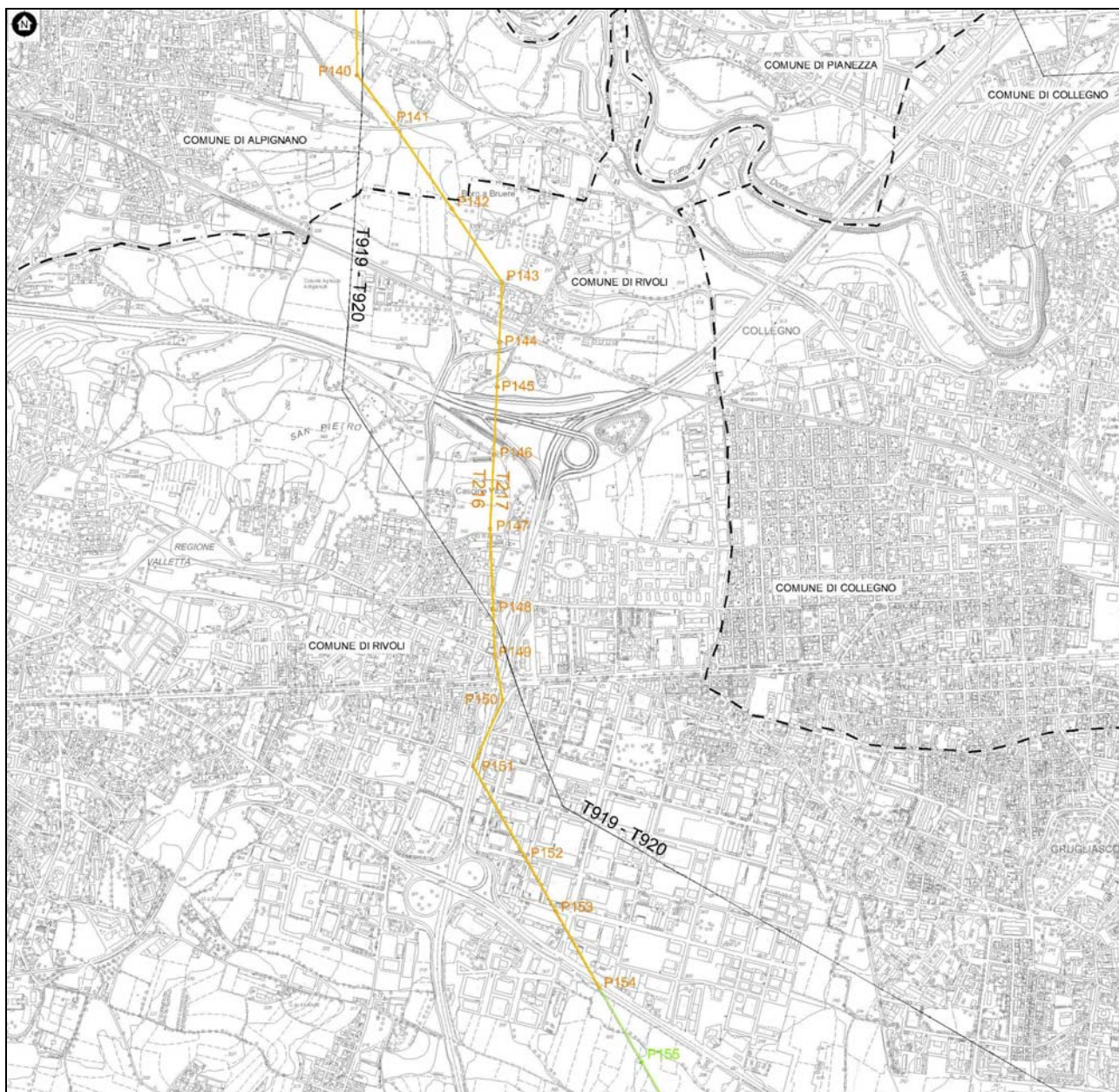
Figura 1.1/2 Linee aeree interessate dagli interventi – In giallo i tratti di prevista demolizione, in verde i tratti inalterati
