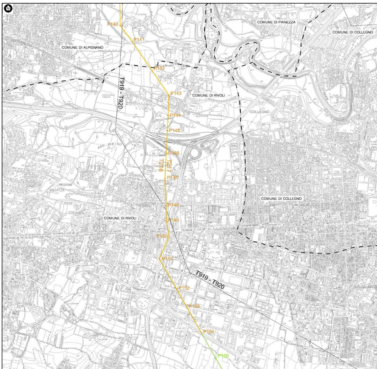
Figura 3.1/2 Linee aeree interessate dagli interventi – In giallo i tratti di prevista demolizione, in verde i tratti inalterati
