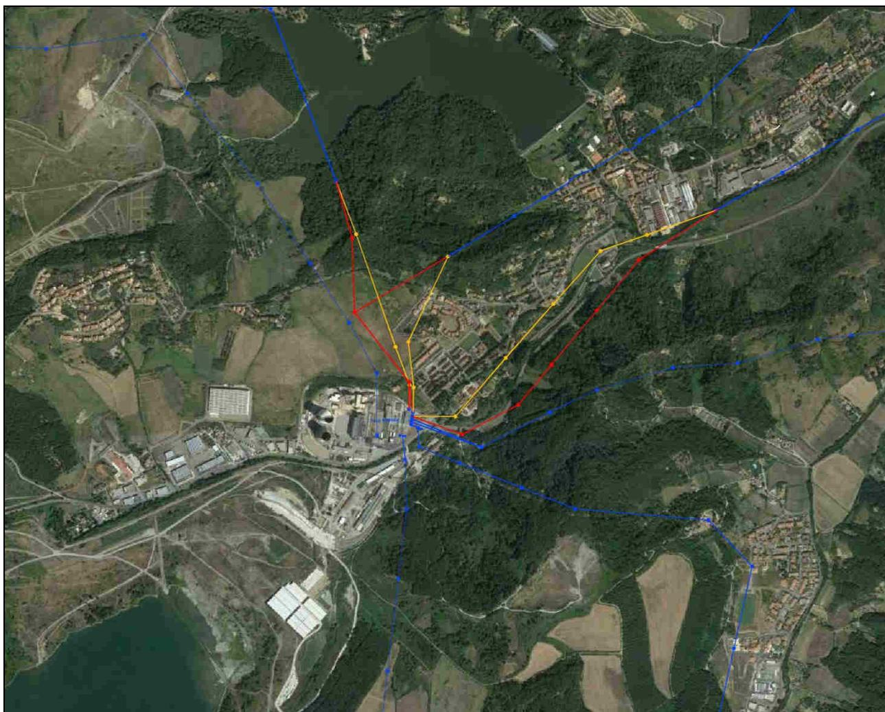
**Immagine 3:** Inquadramento generale e sviluppo della variante degli elettrodotti (in rosso i tratti di variante in progetto, in blu i tratti esistenti ed in giallo i tratti da demolire).
