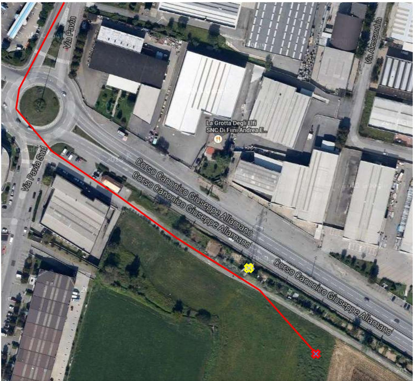
da via Pavia attraversamento di corso Allamano fino al nuovo sostegno portaterminali, in rosso; in giallo il sostegno sotteso, da demolire
