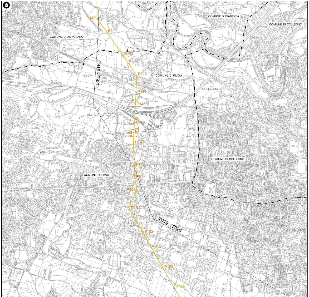
Figura 4.1.b Linee aeree interessate dagli interventi – In giallo i tratti di prevista demolizione, in verde i tratti inalterati
