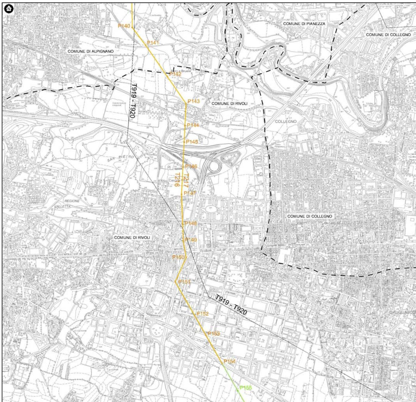
Figura 1.1b Linee aeree interessate dagli interventi – In giallo i tratti di prevista demolizione, in verde i tratti inalterati
