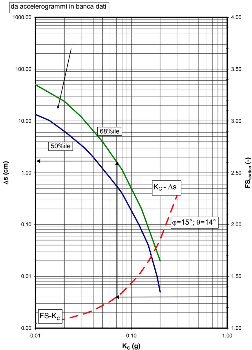
Figura 6.11 - Analisi di pericolosità sismica – Diagramma spostamento –  $k_c$  - FS
