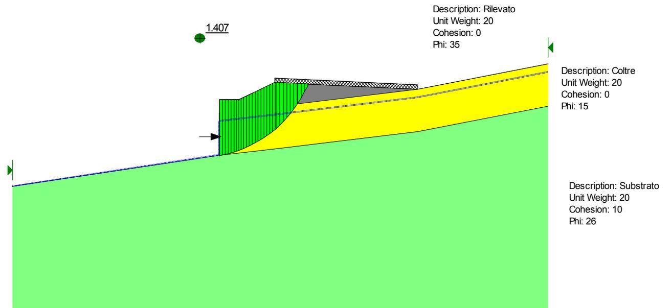
Figura 6.8- Analisi limite per la valutazione dell'azione che stabilizza il cuneo di monte con FS=1.4 nelle condizioni finali
