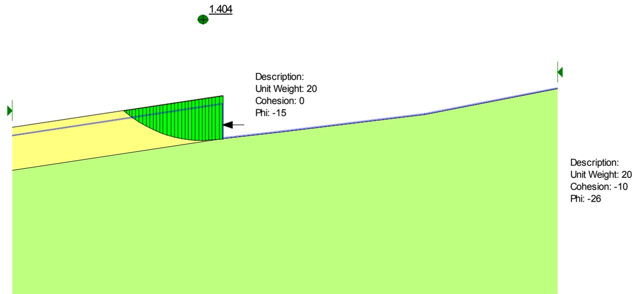
Figura 6.9- Analisi limite per la valutazione dell'azione che instabilizza il cuneo di valle con FS=1.4 nelle condizioni finali
