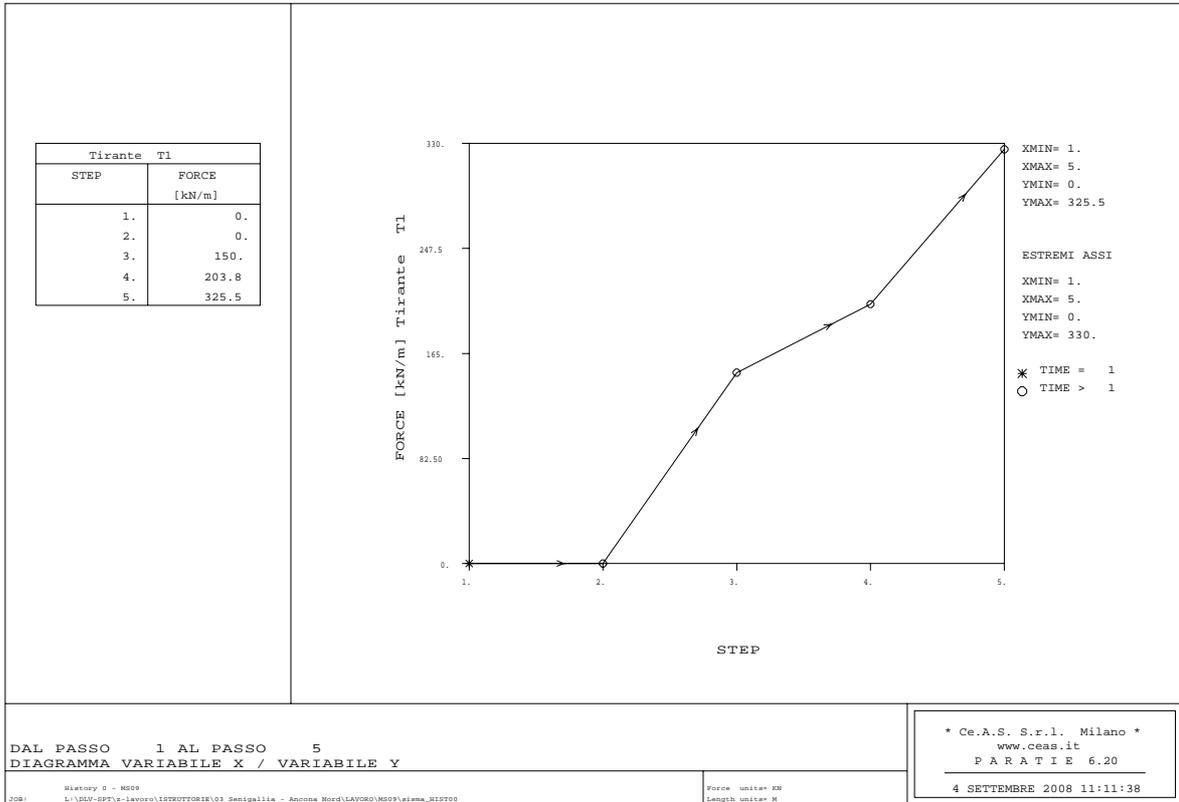
**Figura 6.14 - Programma PARATIE – Tiro nel tirante – Caso sismico**
