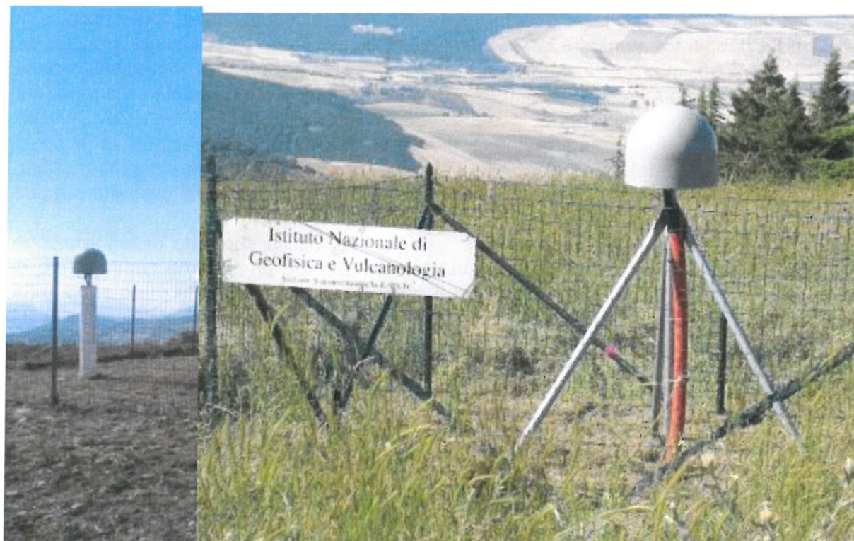
Figura 1 - esempi di monumentazione geodetica per GPS a doppia frequenza, a sinistra su pilastro di cemento armato, a destra su tripode in acciaio ancorato al suolo.
