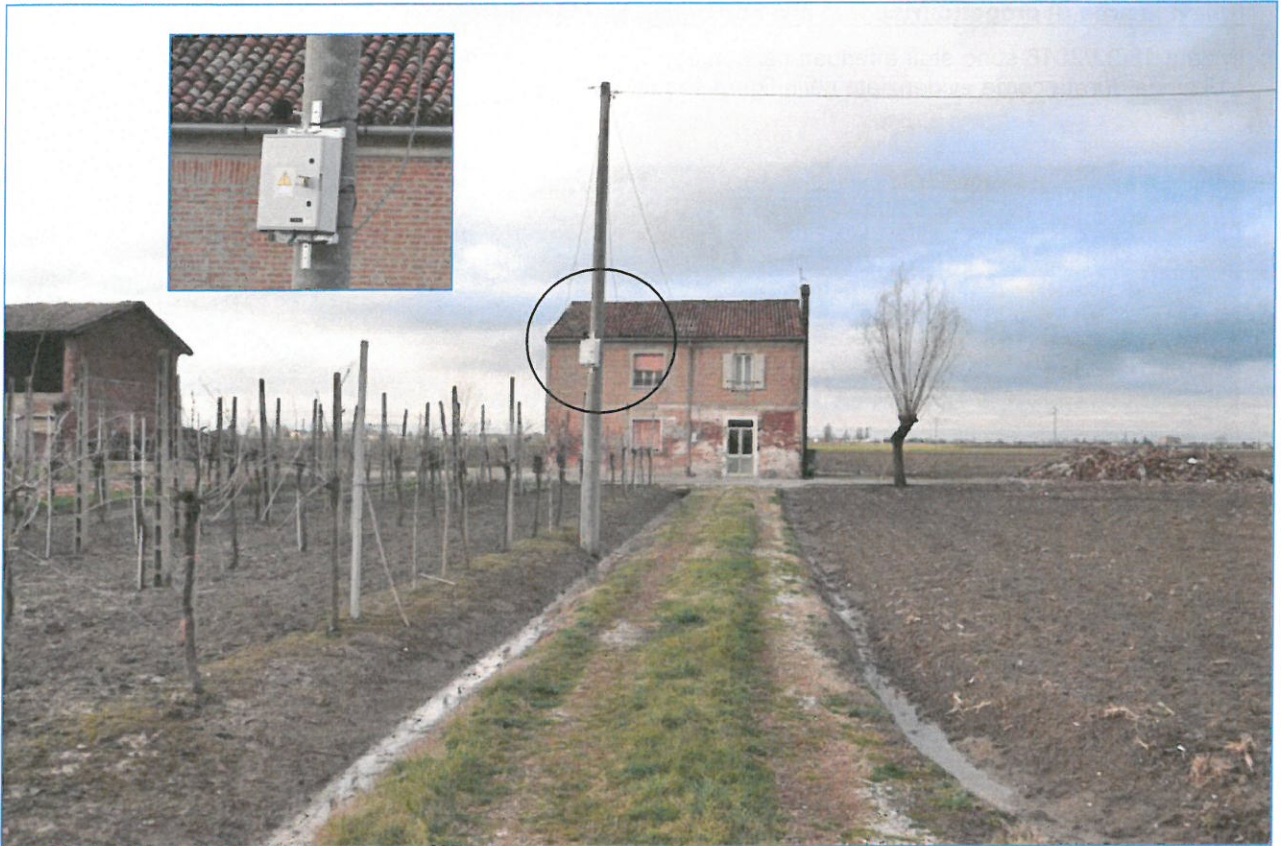
Foto 1 - Fonometro presso R1 (rilievo di lunga durata; distanza dalla recinzione ca. 113 m)
