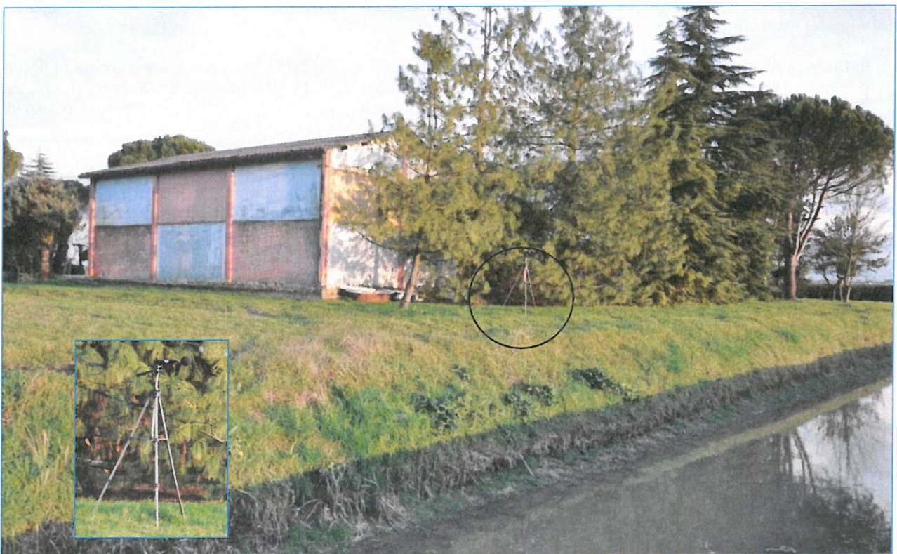
Foto 2 - Rilievo in periodo diurno su R2 (tempo di misura = ca.1 ora; distanza dalla recinzione ca. 468 m)
