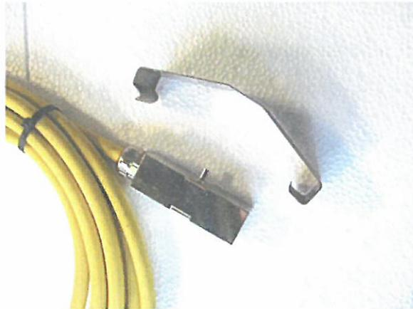
**Figura 3-9 – Sensore di temperatura "RW" posto sotto al contrago con relativa staffa di fissaggio**
