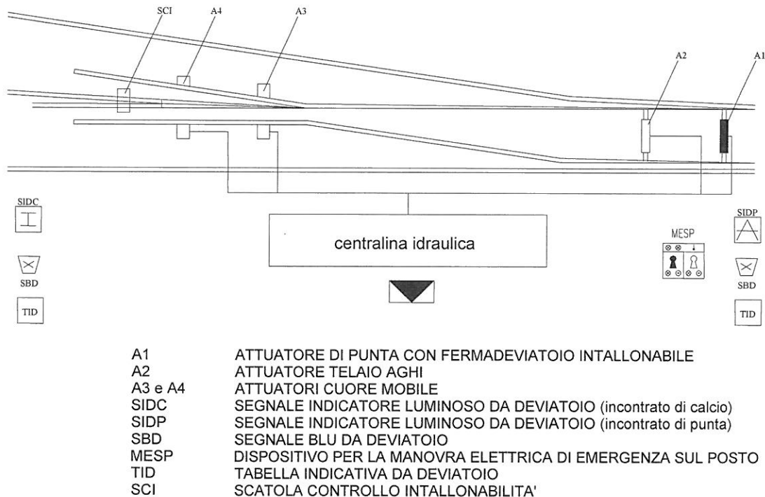
Figura 2 - Sistema Oleodinamico per la movimentazione dei deviatori a punta e cuore mobili a tg. 0.074 (S06)
