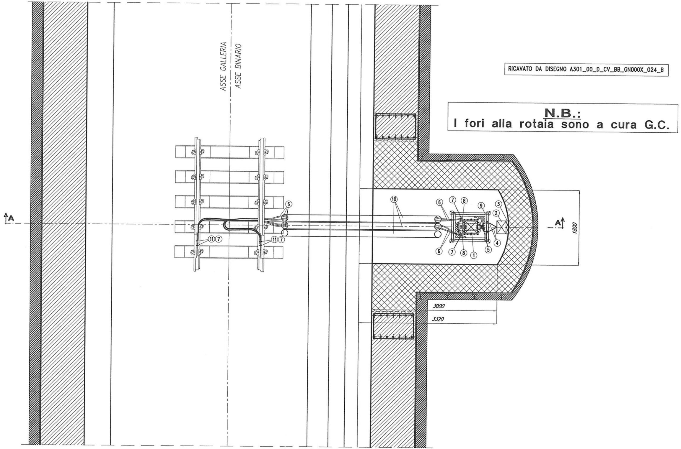
SCHEMA GENERALE PER C.I. DI SBARRAMENTO 500 A - SEZIONE B-B - PIANTA
