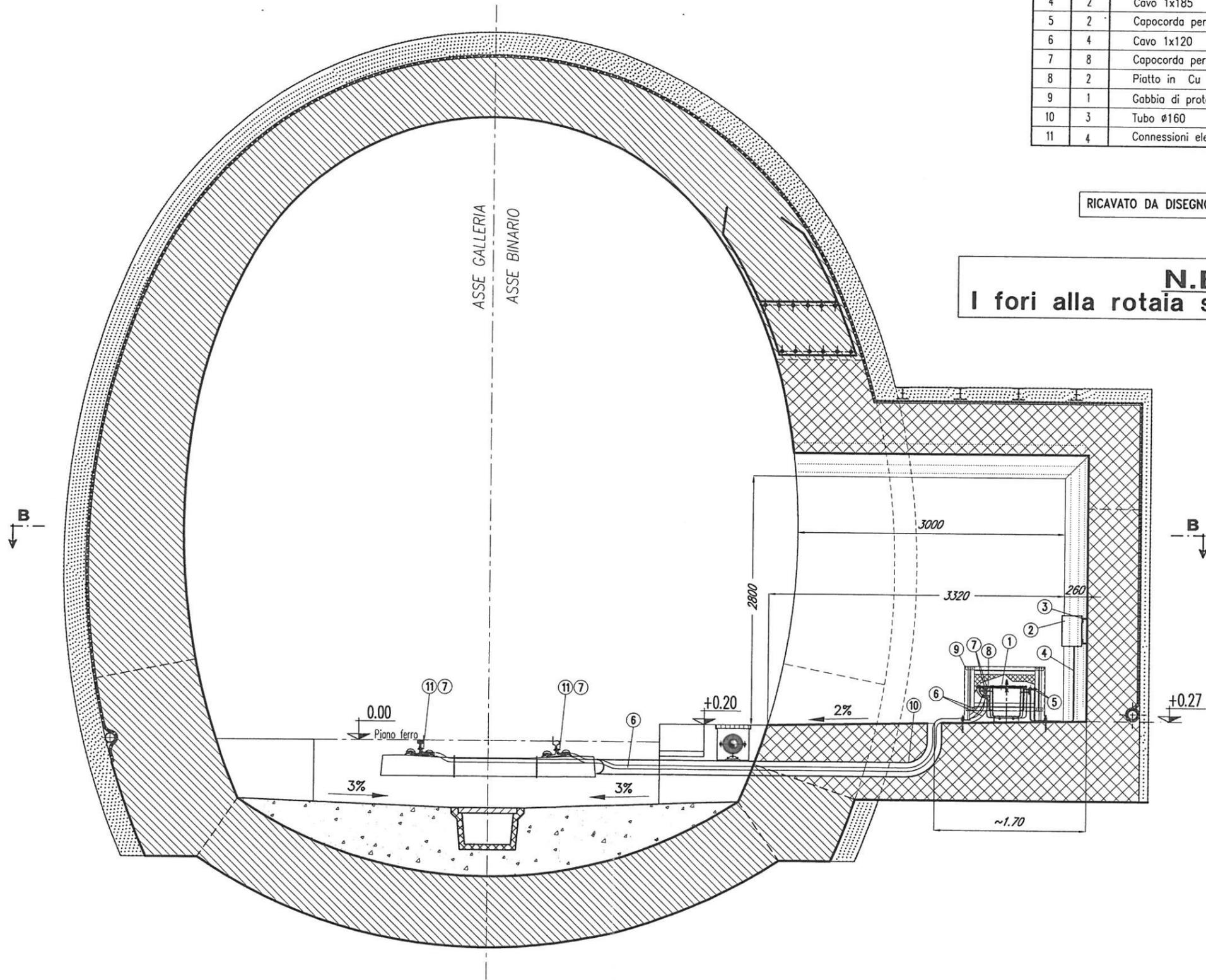
SCHEMA GENERALE PER C.I. DI SBARRAMENTO 500 A - SEZIONE A-A
