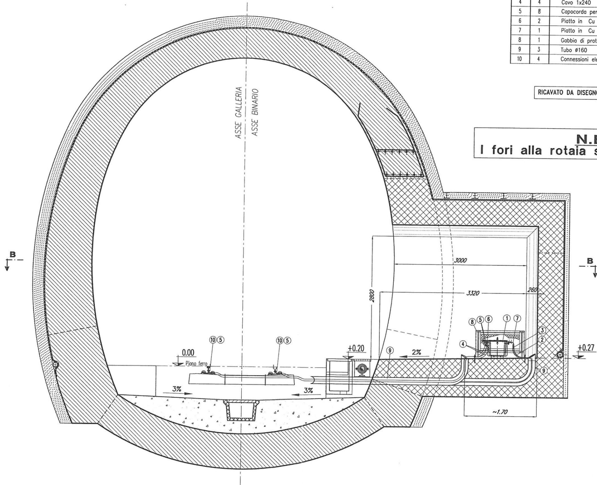
SCHEMA GENERALE PER C.I. DI RITORNO 1000 A - SEZIONE A-A
