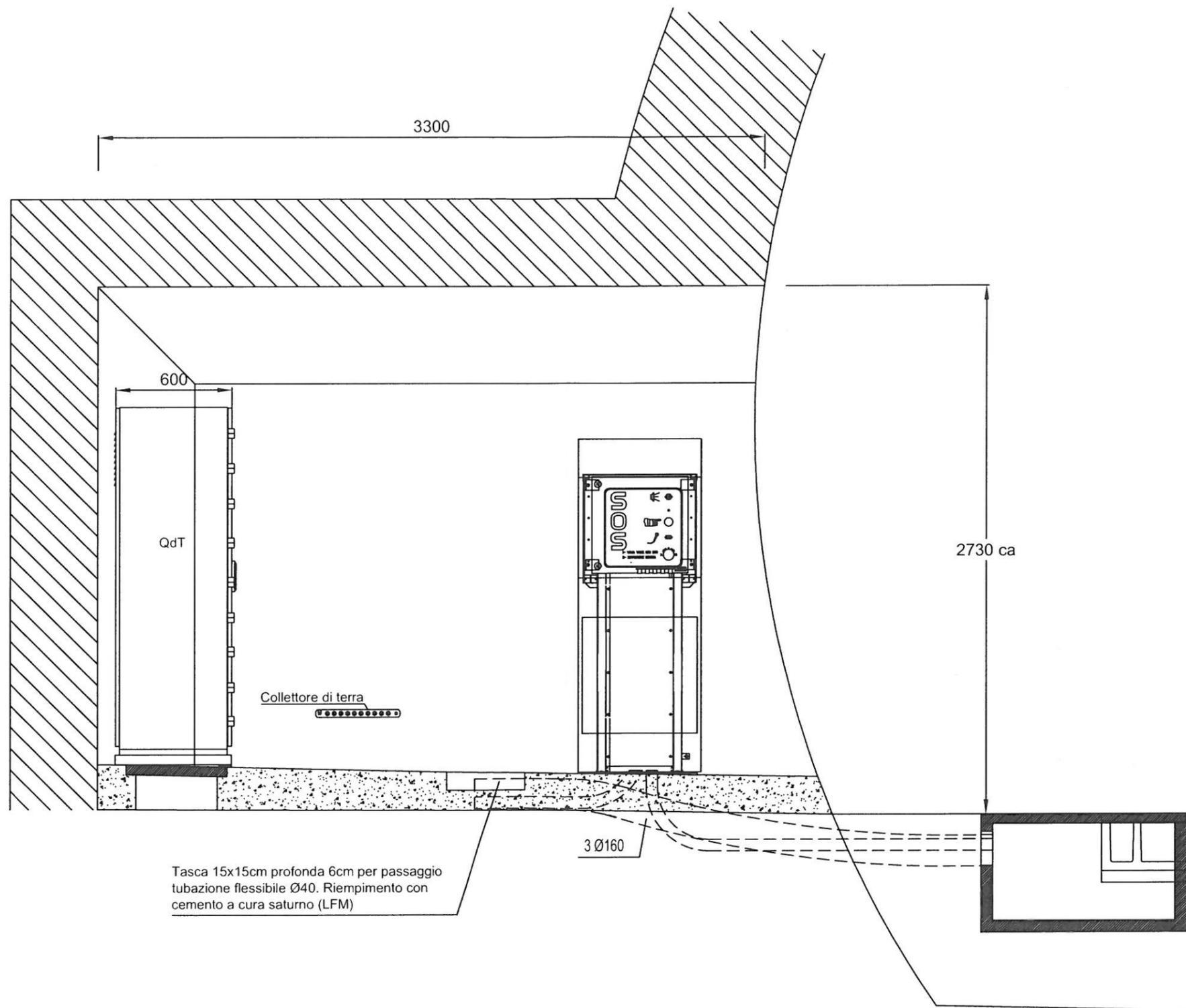
Tasca 15x15cm profonda 6cm per passaggio tubazione flessibile Ø40. Riempimento con cemento a cura saturno (LFM)
