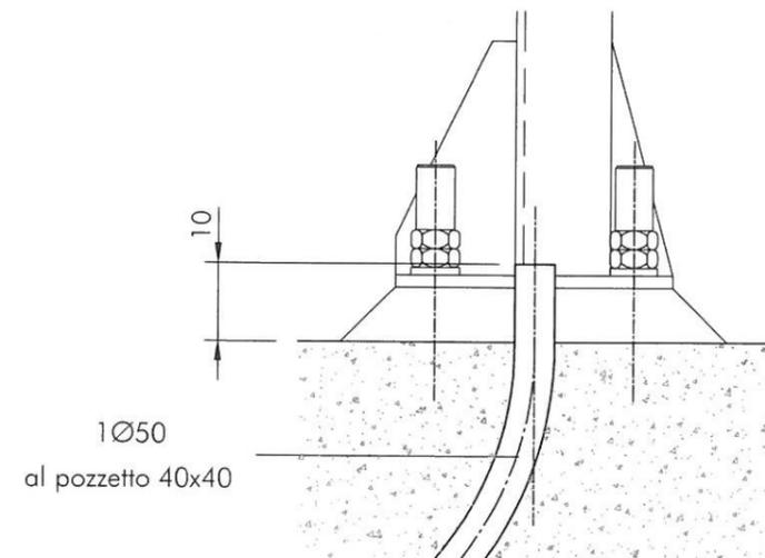
BASAMENTO TRALICCI ANTENNE
