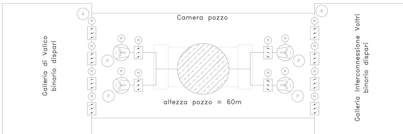
Schema di principio ventilazione pozzo n.4
