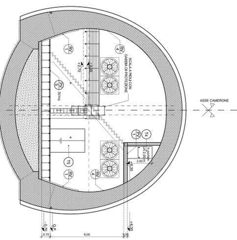
SEZIONE TRASVERSALE M-M SCALA 1:100
