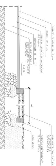
PART. PAVIMENTAZIONE STRADALE E SUPERFICIE INGHIAIATA
