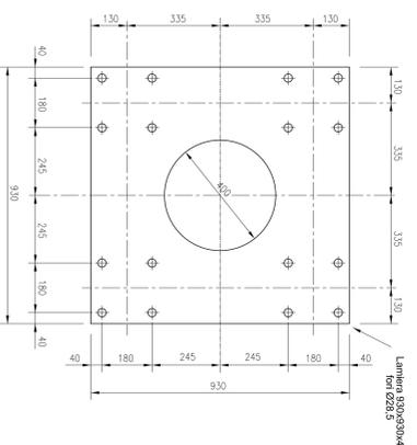
PARTICOLARI BASAMENTO TRALICCIO ANTENNE scoda 1:25
