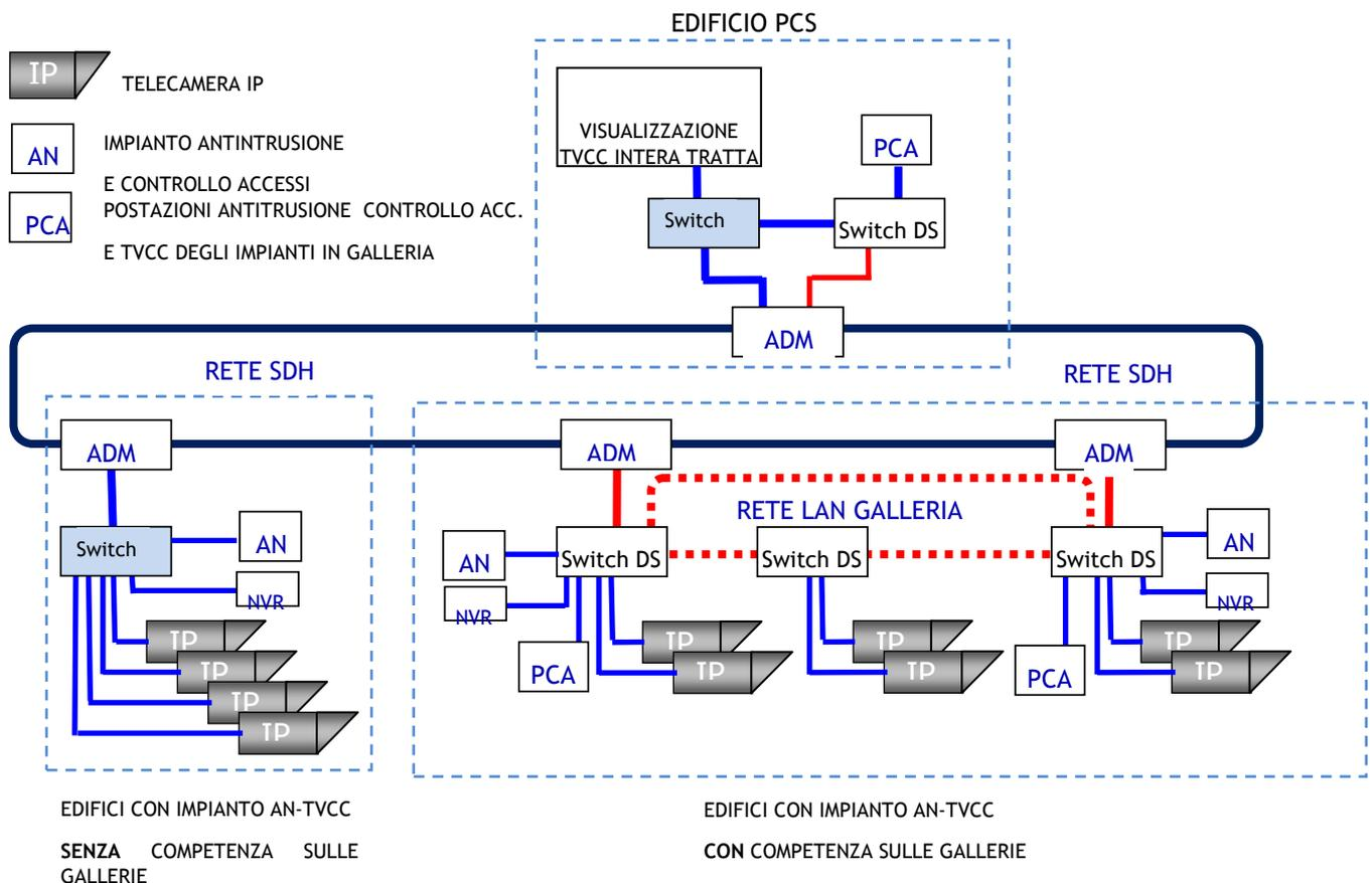
Nei PGEP primari sarà presente una postazione Server del sistema Protezione Controllo Accessi (PCA) per la gestione degli impianti Antintrusione e TVCC della galleria di competenza e per l'interfaccia con il sistema SPVI.
