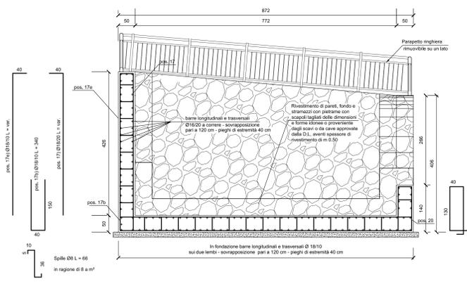
Pozzetto di uscita Vv- Sezione L-L scala 1:50
