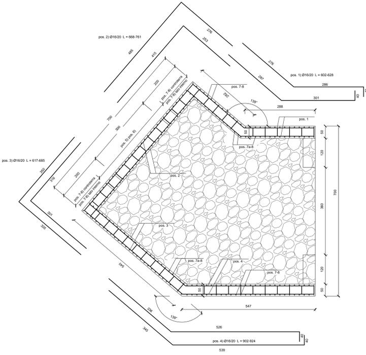
Pozzetto di uscita Vv- Sezione Q-Q scala 1:50
