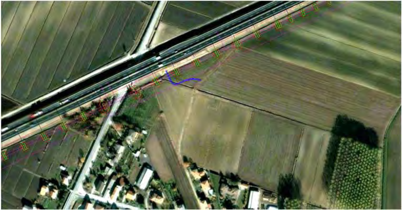
Figura 5.8.1 Deviazione canale irriguo II presa
