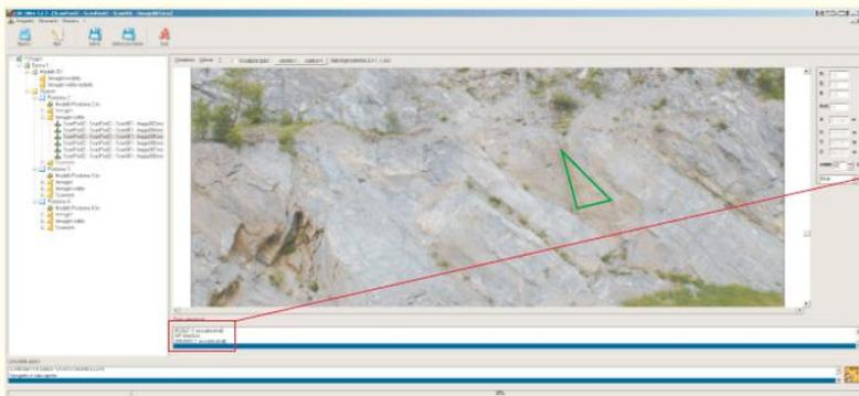
c. La combinazione delle informazioni date dagli elementi dei punti a. e b. mediante il software LSP2004 (proprietà del Politecnico di Torino) fornisce delle "immagini solide" che consentono la misurazione tramite modello della posizione nello spazio di un piano, evidenziato dal triangolo verde nella figura. La misura fornisce il DIP e il DIP D/R del piano.
