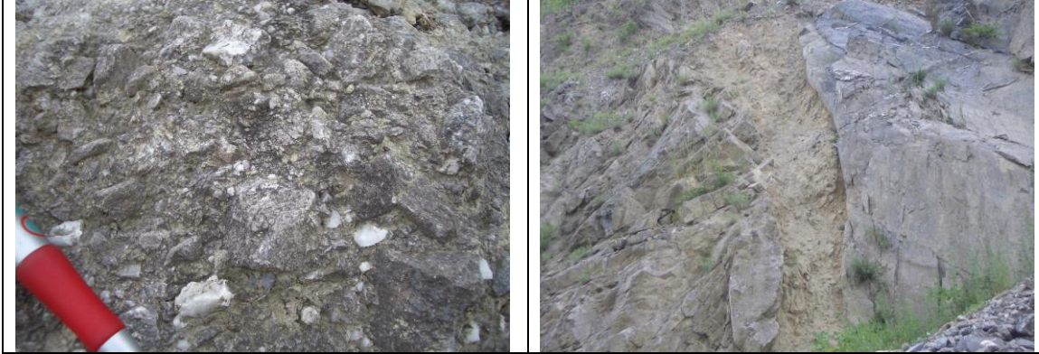
Figura 7: sinistra: breccie cataclastiche coesive non alterate. Destra: breccie di faglia alterate (lo spessore medio è di circa 1 m).
