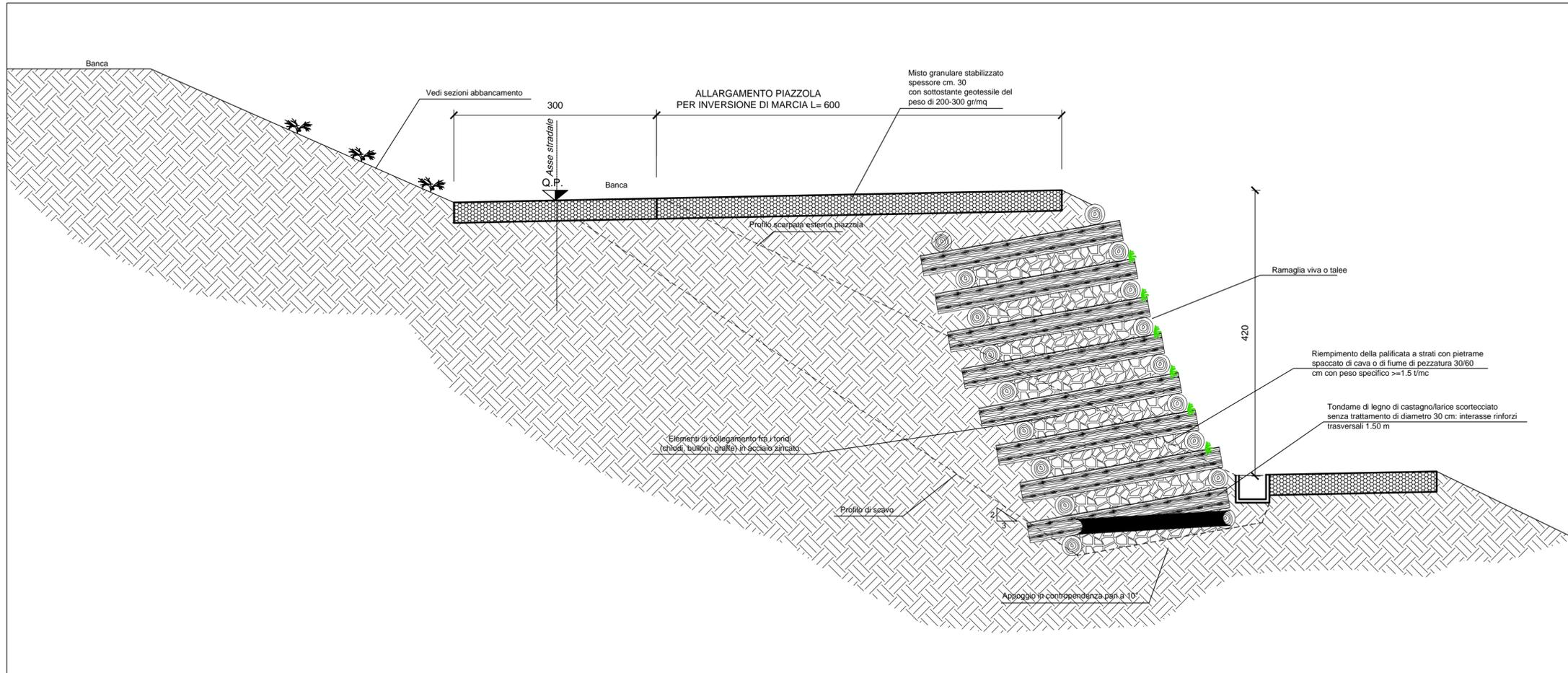
SEZIONE TIPO VIABILITA' PISTA LUNGO LE BANCHE scala 1:50
