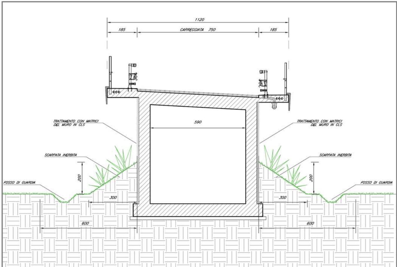
*Sezione tipologica del cavalferrovia su scatolare con mitigazioni paesaggistiche*
