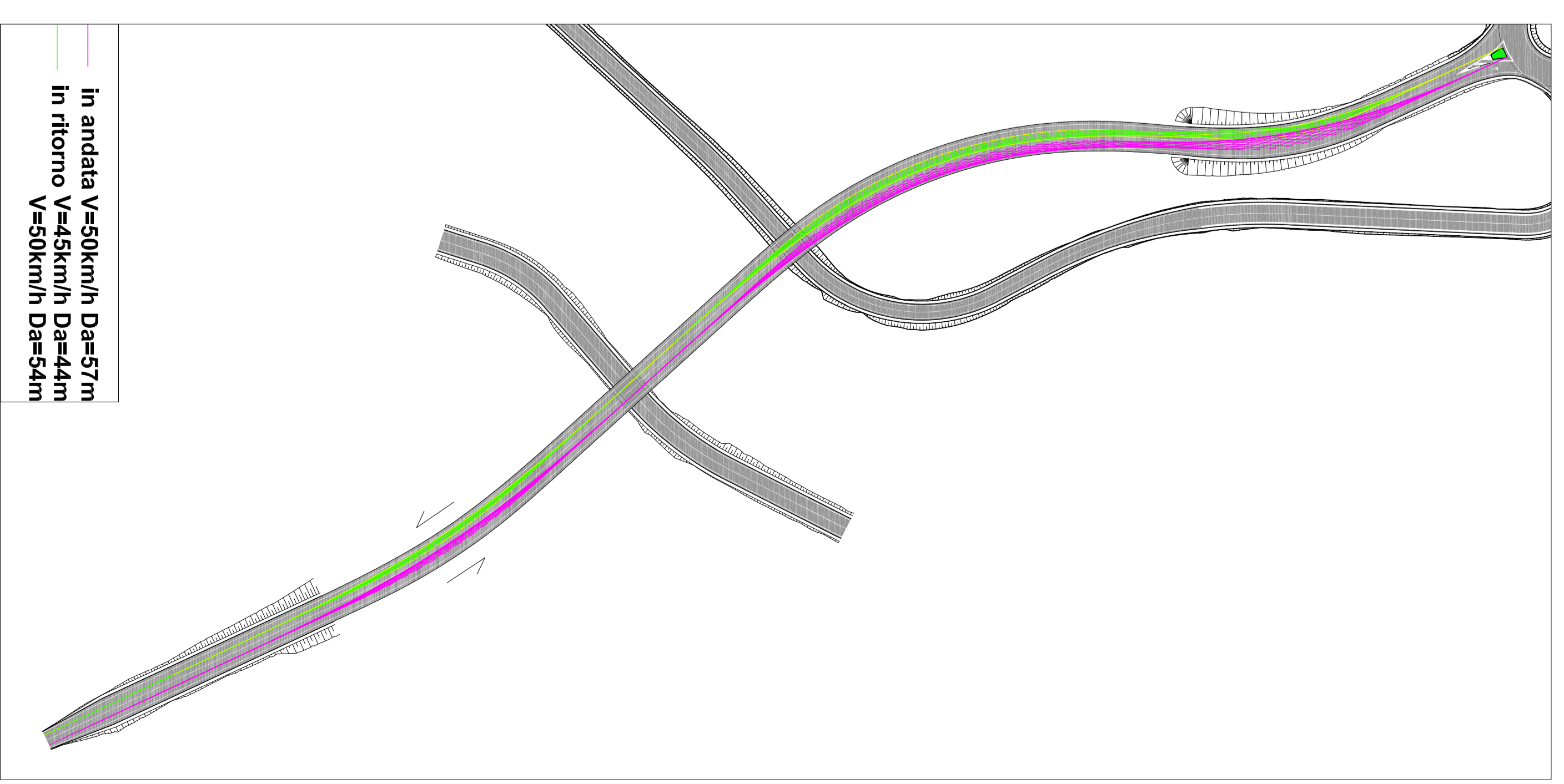
Verifica di visibilità in curva NV 05
